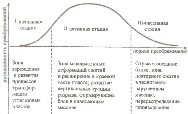
Рис. 2 – Схема модели развития трансформации углеводородов в системе "уголь-газ" и техногенных преобразований в геологической толще
